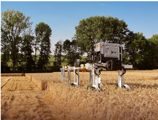
Abb. 1 Der Feldroboter DeBiFix untersucht ganze Weizenfelder auf den Wachstumsverlauf der Körner in den Ähren. Auf dieser Grundlage kann entschieden werden, welche Sorten sich besonders gut für die Züchtung eignen.
